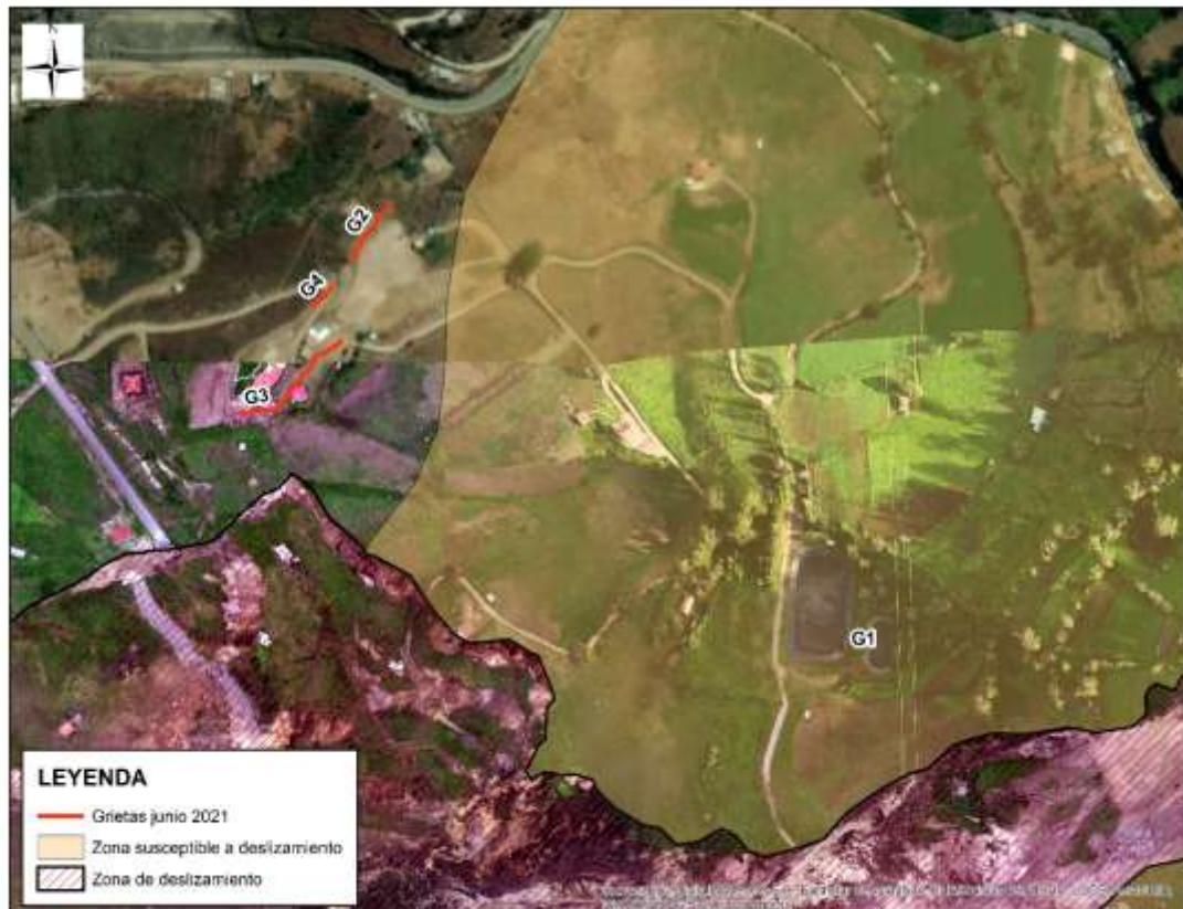
Figura 2: Ubicación de los lugares donde se evidenció nuevas grietas en el sector La Armenia.
